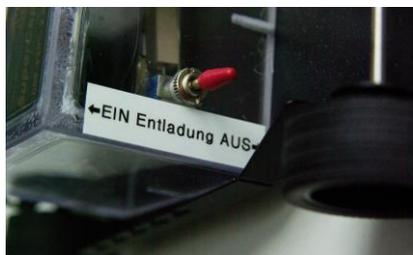
**Abb. 2: Schalter zum Entladen des Kondensators**
