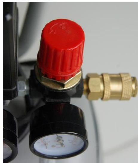
**Abb. 7: Drehknopf zum Justieren des Drucks in der abgehenden Leitung**
