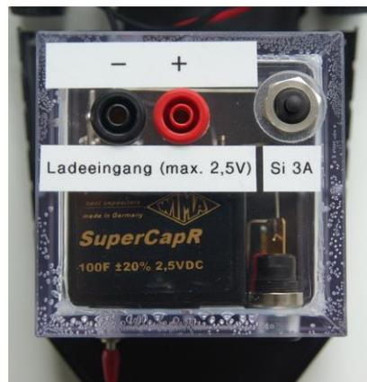
**Abb. 1: Kondensator und Ladebuchsen**
