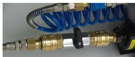
**Abb. 8: Absperrhahn vor dem Druckluftmotor**
