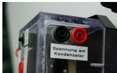
**Abb. 3: Buchsen zur Überprüfung der Kondensatorspannung**
