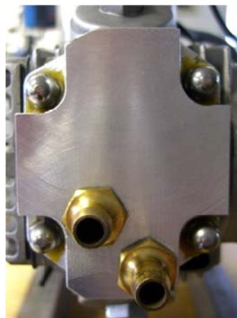
Abb. 4.3: Wärmetauscher am Zylinderkopf
